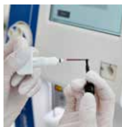
3. För över provet till adaptorn
